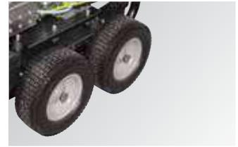
Ruedas espumadas de efecto neumático de goma maciza y llantas de acero de 300 mm de diámetro para la estabilidad de posicionamiento y para operaciones de desplazamiento
